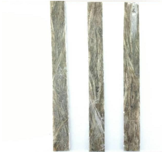
Fig.2. Tensile Test Specimens
