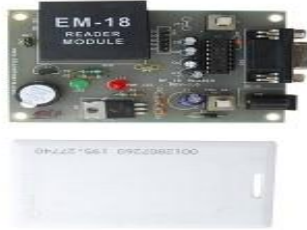
Fig.4.1. RFID Reader Module
