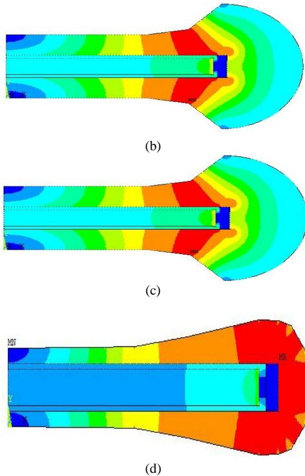
Fig. 8: Magnetic flux density variation of (a) Rectangular, (b) Dumbbell, (c) Shell type, (d) 7-segment
