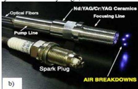
Fig: 3.2 Laser Igniter & Spark Plug
